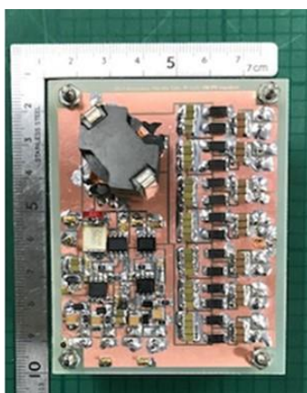
図 4.3 定格 60 W の試作回路
