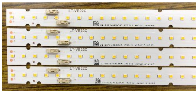
図 4.1 想定する LED ストリング (SAMSUNG LT-VB22C)
