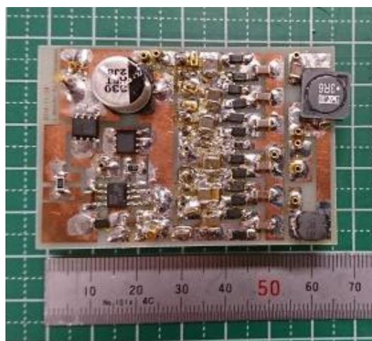
図 4.1. インダクタ分圧方式 1-W プロトタイプ
